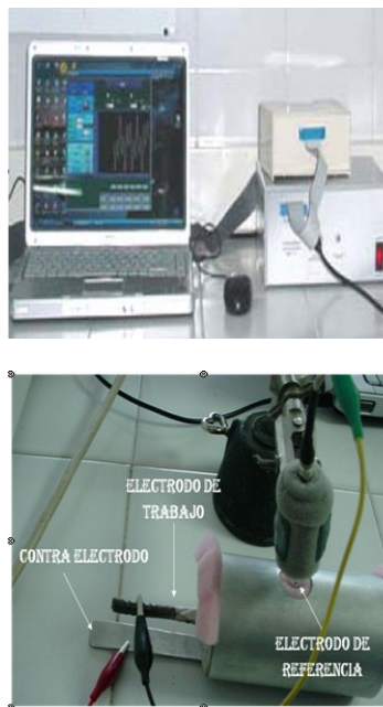
Fig.2 Sistema potencioestático elaborado para implementar la técnica EFM.
