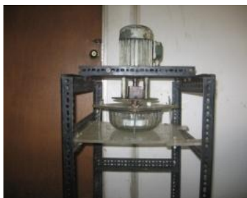
Fig. 1. Equipo construido para ensayos de corrosión-erosión
