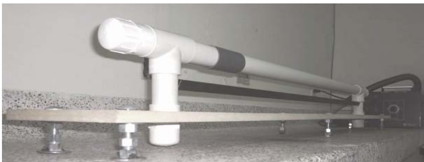
Figura No.1. Vista general del riel de aire y el compresor utilizado para la experiencia.
