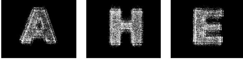
Figura 3. Lectura de hologramas multiplexados en un cristal BSO.
