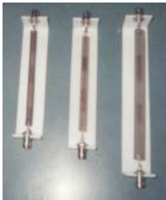
Figura 2. Microstrips. De izquierda a derecha: M1, M3 y M2.
